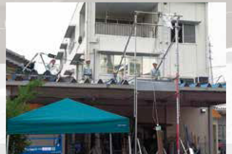
86kg 落下阻止性能試験の様相 (平成25年10月実施)
