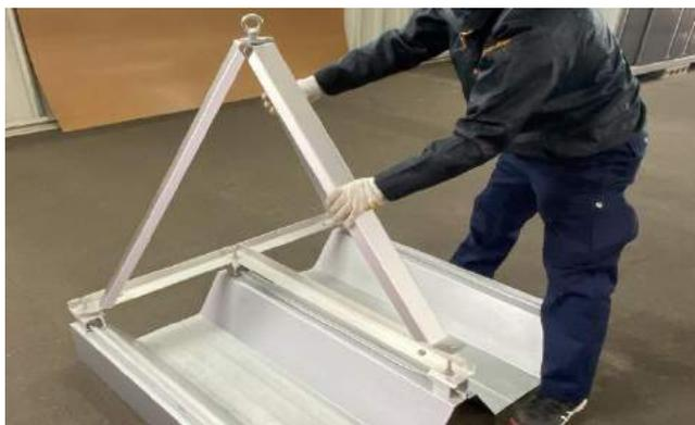
⑦ **Iボルト**を軸とし、ナットをゆるめながら3枚のフレームを左図のように開きT字フレームのナットを外したボルトに穴を合わせる。
