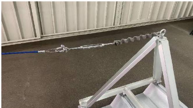
⑧ ⑦で加工したリングをターンバックルの**シャックルに固定**する。
