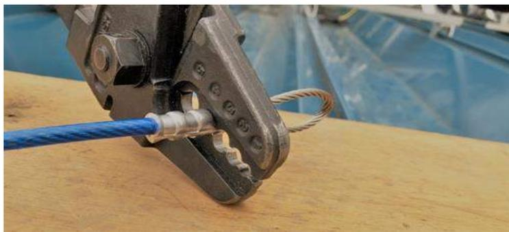
③ スレージャの**4mm**のくぼみにアームを縦方向に入れ、アームを**3カ所**つぶし、リングを固定
