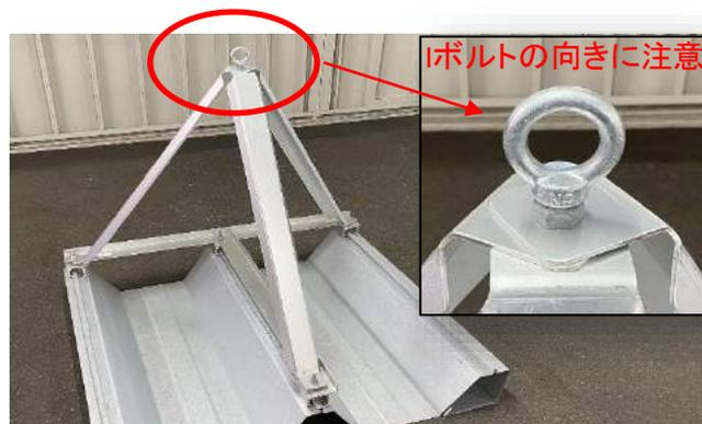
⑧ ナットを**17mmのビット**で固定し、上部**Iボルト**下のナットを**21mmのビット**で固定。その時**Iボルト**は**ワイヤー設置方向**に合わせておく。
