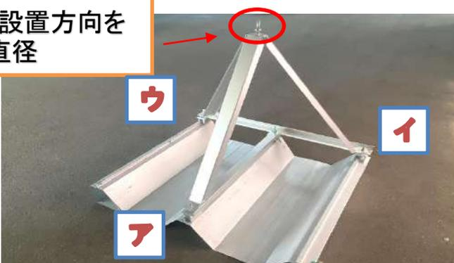
⑤ 三脚支柱(A)を開きア、イ、ウのボルトに支柱の脚の穴を通し、外したナットで固定、上部Iボルトの向きをワイヤ設置方向に円の直径側になるようインパクトの21mmのビットで上部を固定し、17mmのビットでア、イ、ウのナットを固定。
