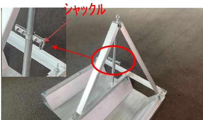
④ 床バントを任意の高さに図の向きで合わせ、外側1ヶ所以外の3カ所を付属のボルトナットを13mmのビットで固定し、残りの1か所はシャックルを取付け、プライヤー等でしっかりと固定する
