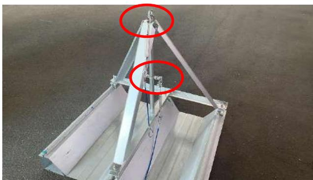
⑤ 上部リングと中段のシャックルにターンバクルのシャックル側を取付け、プライヤー等でしっかりと固定する
